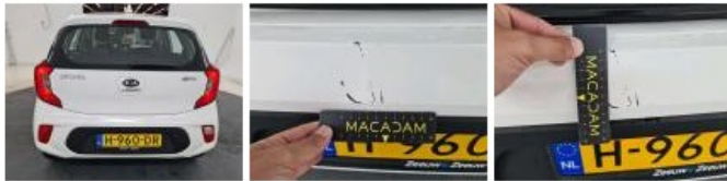
Dorpel L, Deuk(en) en kras(sen), Herstellen en spuiten (compleet)
