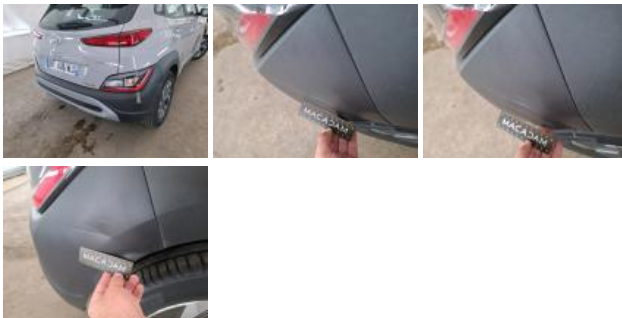
Pare-chocs AR, Déformé / Forcé, E - Remplacer
