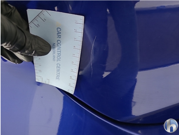
1. diverse Gebruikssporen - Aanvaardbaar
