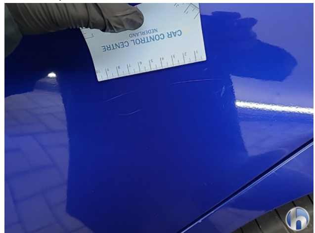
1. Portier achter - links Krassen - Spuiten
