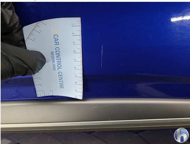
1. Portier achter - links Krassen - Spuiten
