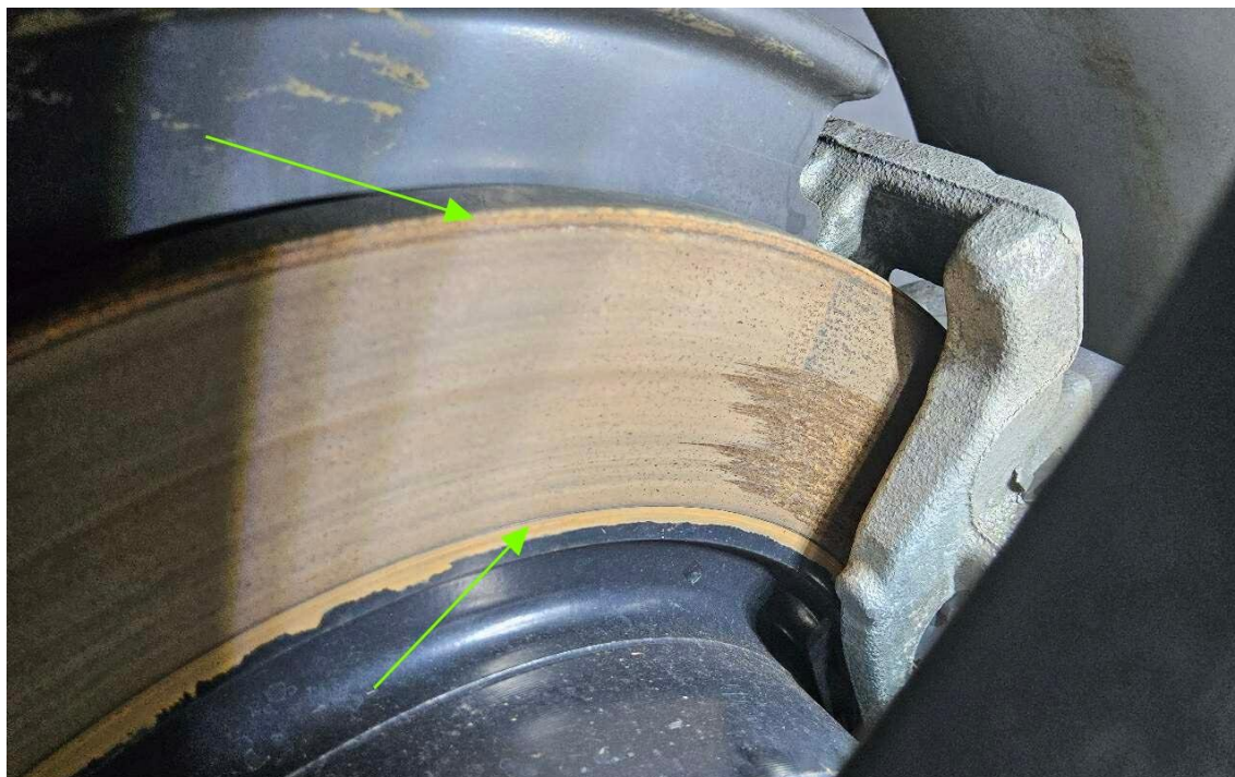
Bild 9 : Korrosionsbildung Bremse - Freibremsen erforderlich
