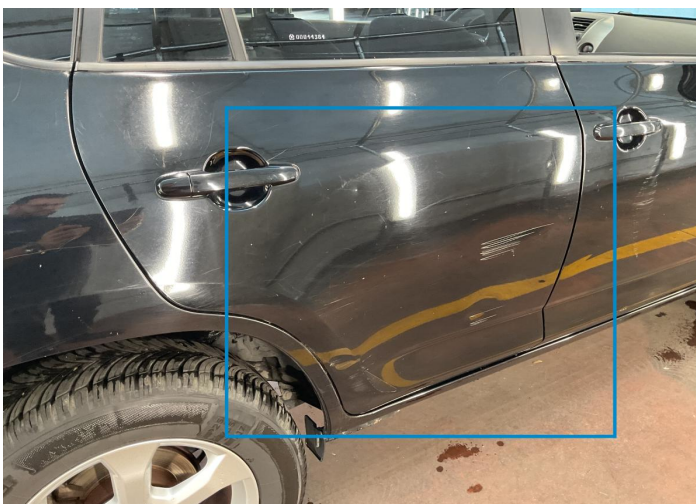
20. Door / Back Right Bodywork / Dent -
