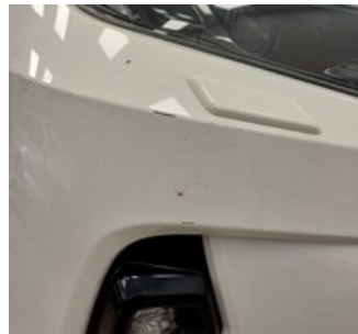
7.4.1 - Stötfångare fram Färgbättring litet skav stöt hf. Kan färgbättras
