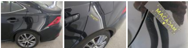
Deur A L, Roest / Corrosie, Herstellen en spuiten (gedeeltelijk)
