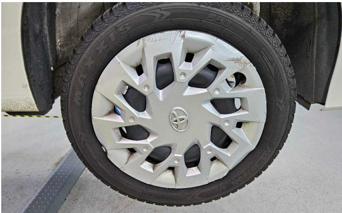
Bild 26 : Radzierblenden vorne zerkratzt - Minderwert angesetzt
