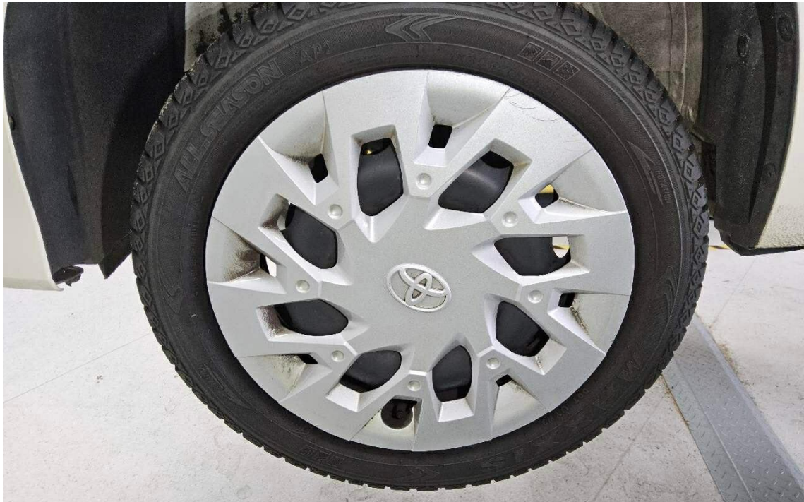
Bild 25 : Radzierblenden vorne zerkratzt - Minderwert angesetzt
