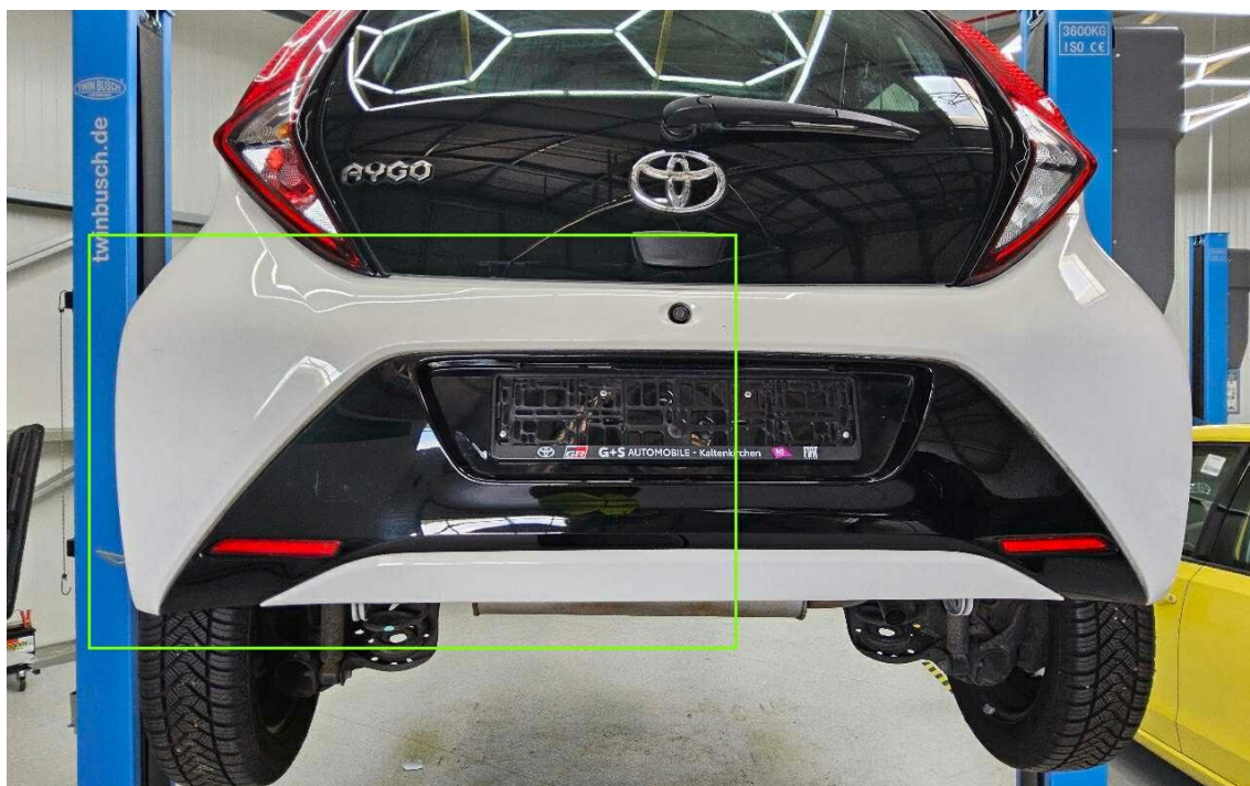
Bild 18 : Stoßfänger hinten zerkratzt und plastisch verformt
