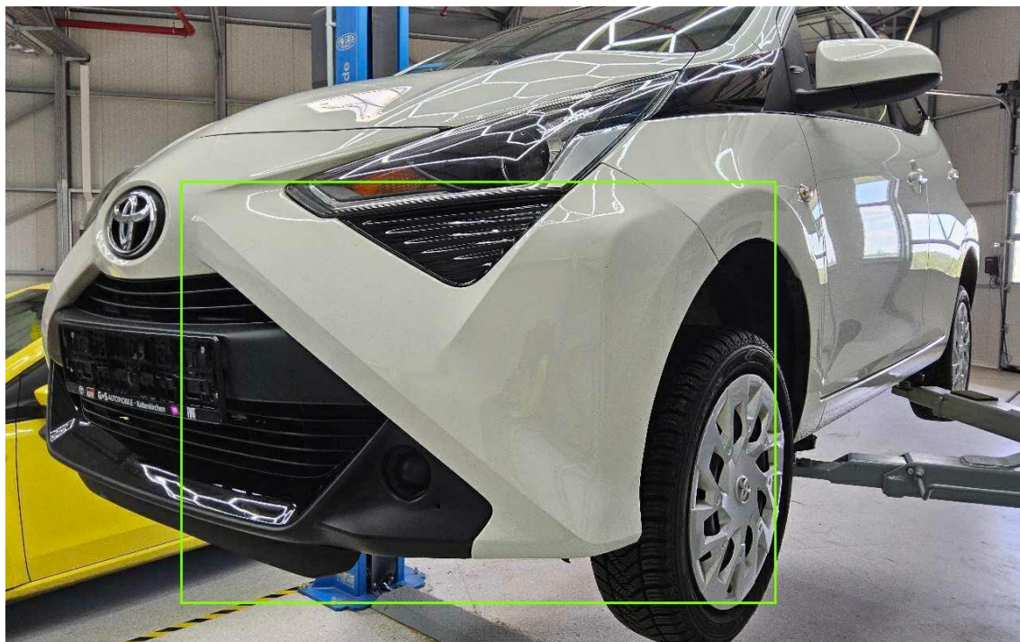
Bild 11 : Stoßfänger vorne plastisch verformt
