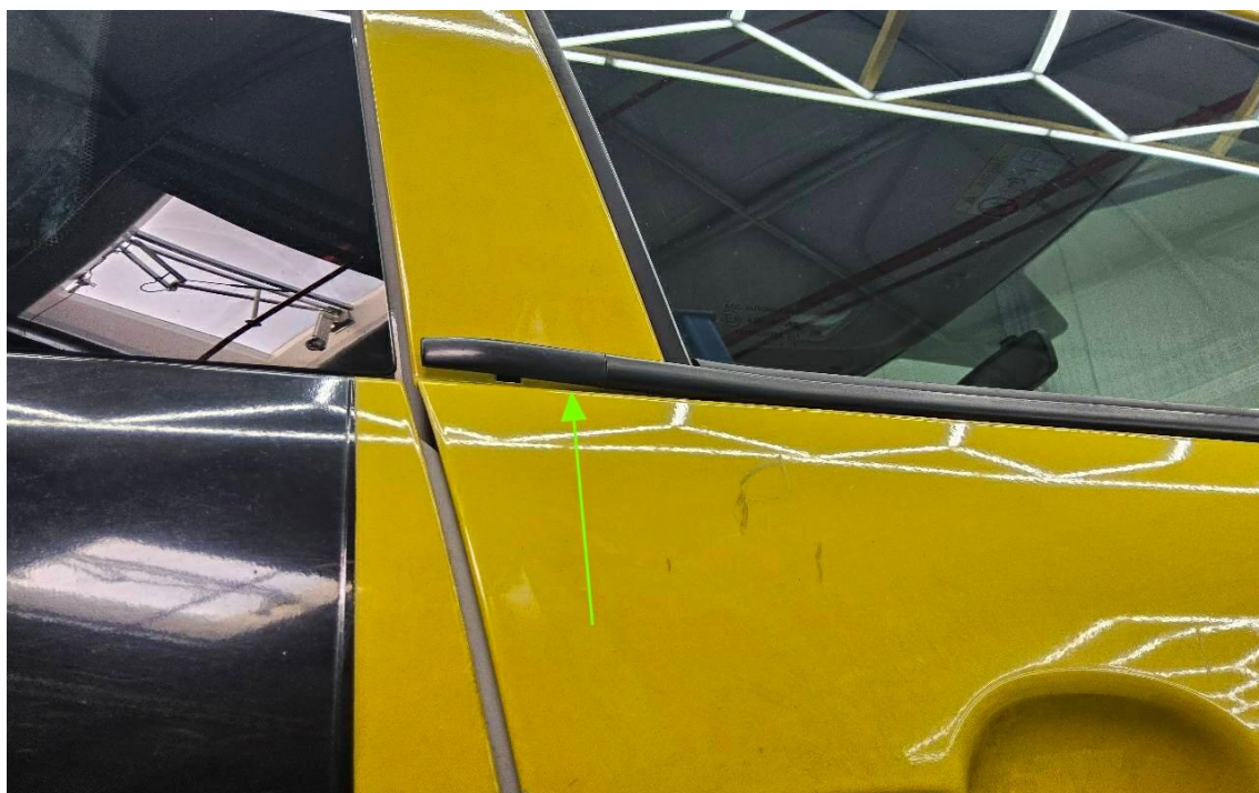
Bild 26 : Schachtleiste Tür vorne rechts Befestigung mangelhaft
