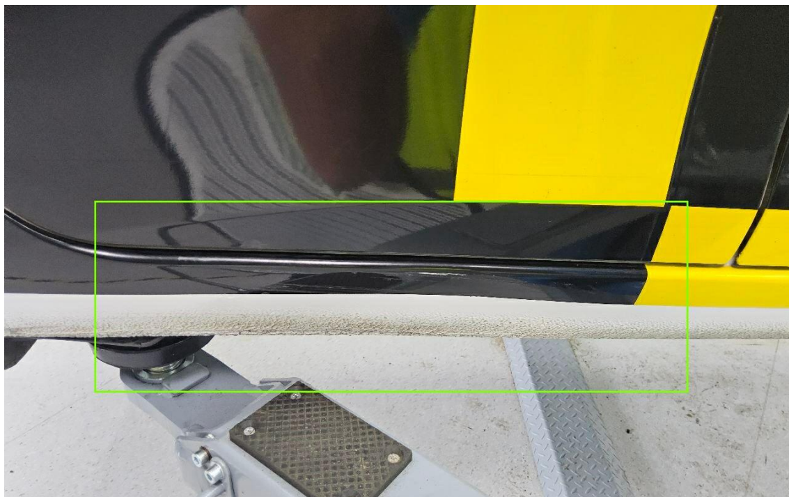
Bild 29 : Schweller rechts deformiert
