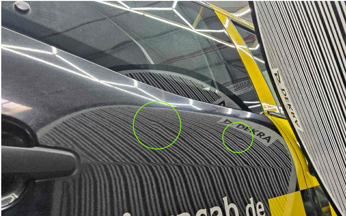
Bild 27 : Tür hinten rechts mehrfach eingedellt
