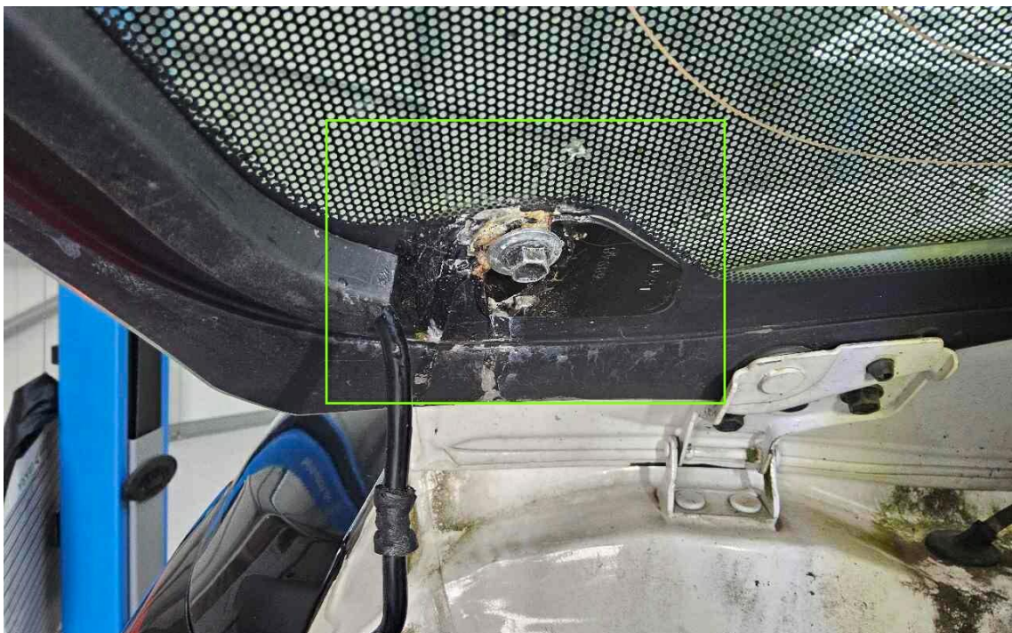
Bild 12 : Dämpfer Heckklappe verschlissen/fehlt
