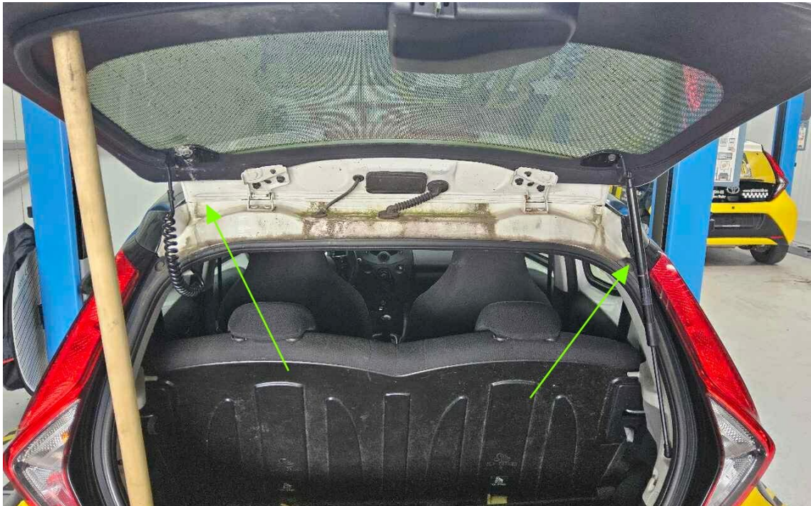
Bild 11 : Dämpfer Heckklappe verschlissen/fehlt
