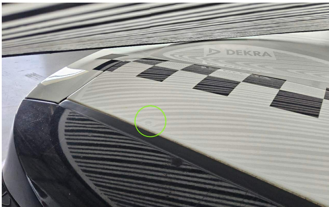
Bild 16 : Dach mehrfach eingedellt
