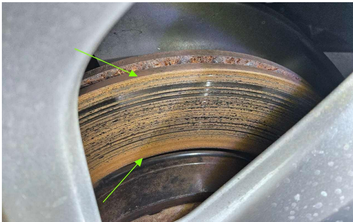
Bild 9 : Korrosionsbildung Bremse - Freibremsen erforderlich
