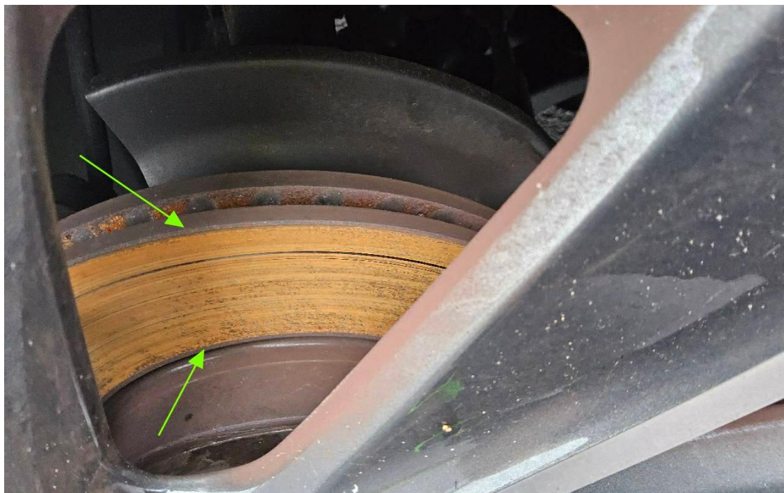
Bild 8 : starke Korrosionsbildung Bremse vorne
