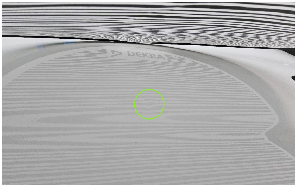
Bild 12 : Dach mehrfach eingedellt
