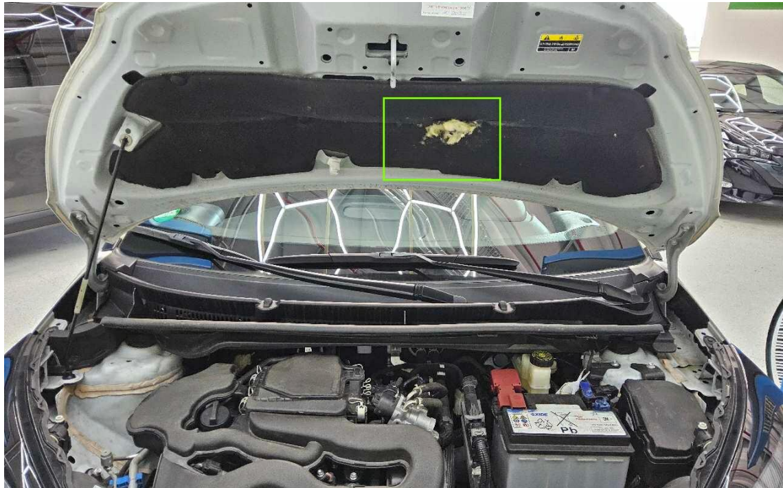
Bild 7 : Tierbisspuren Motorraum - Mehrkosten möglich
