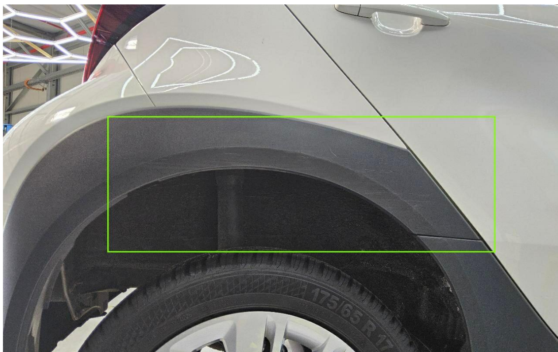
Bild 16 : Zierblende Radlauf rechts zerkratzt
