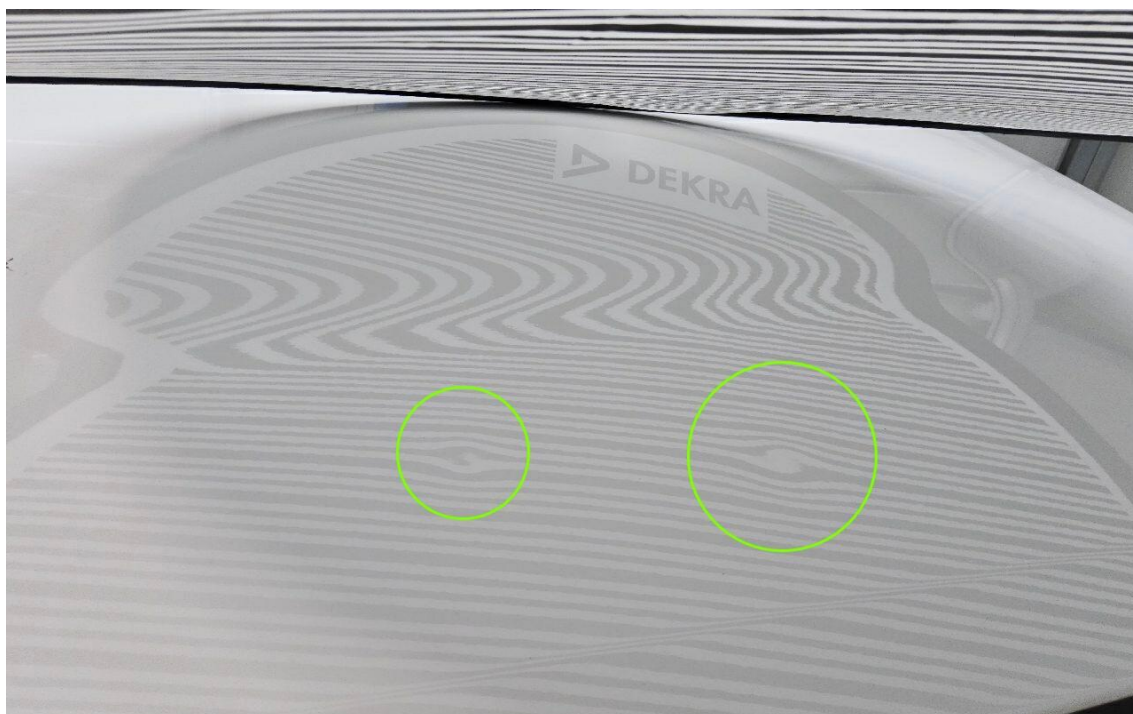
Bild 10 : Dach mehrfach eingedellt
