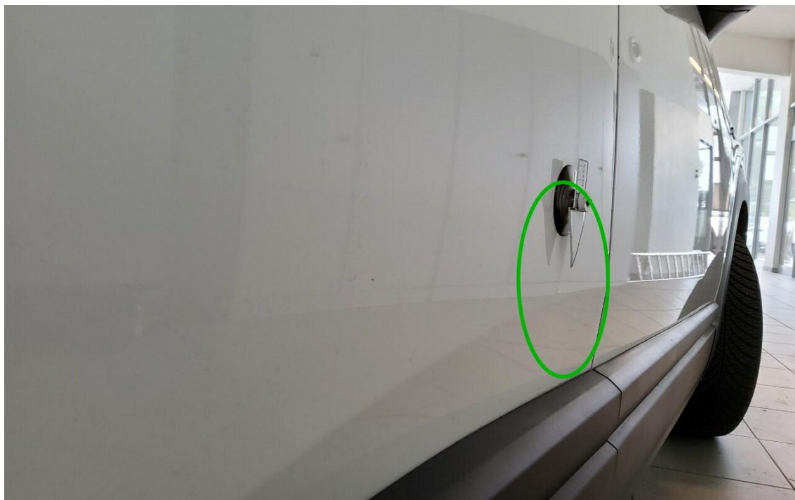
Bild 16 : Tür hinten rechts, eingedellt, drücken
