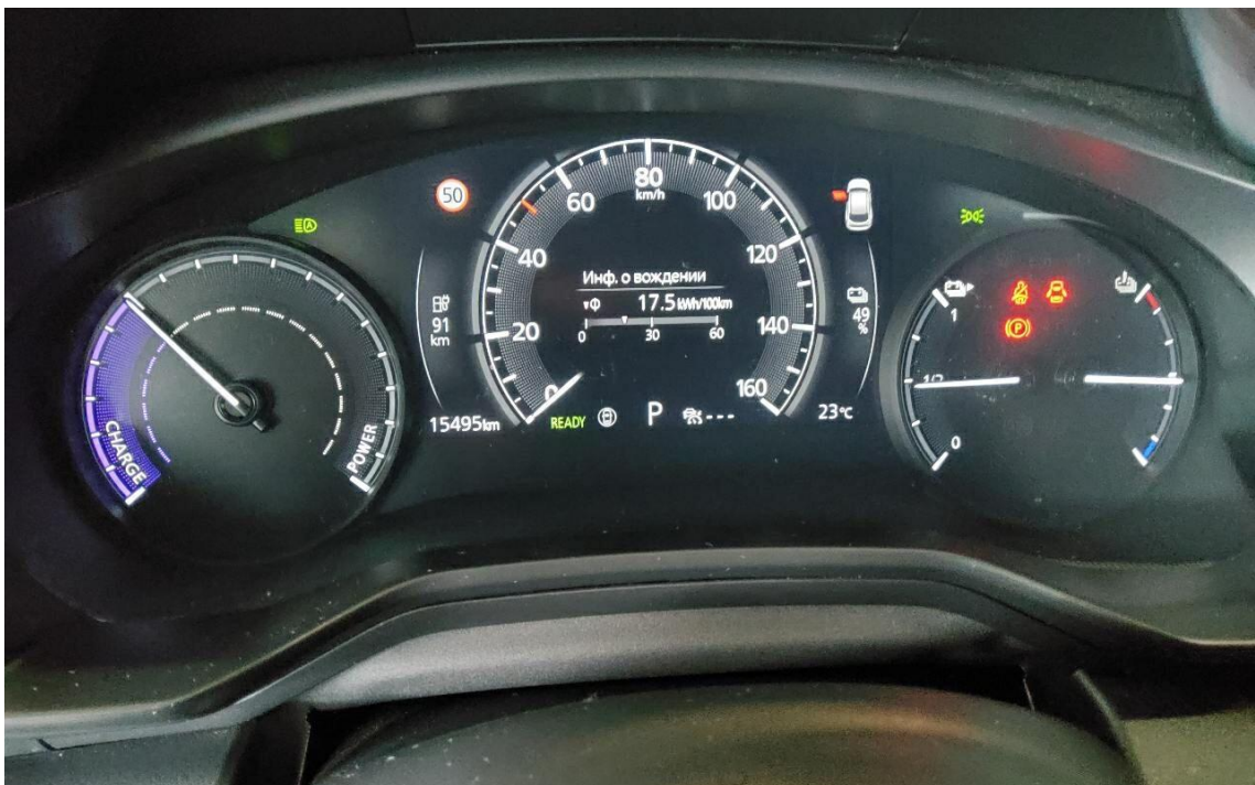
Bild 6 : Kombiinstrument (betriebsbereit) mit Km-Stand
