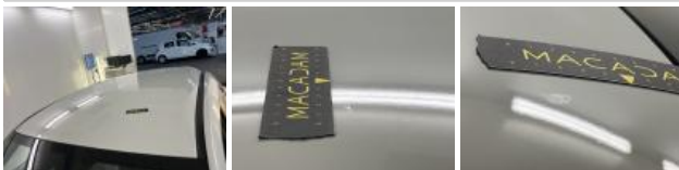
Dak, Chemische schade, Herstellen en spuiten (compleet)
