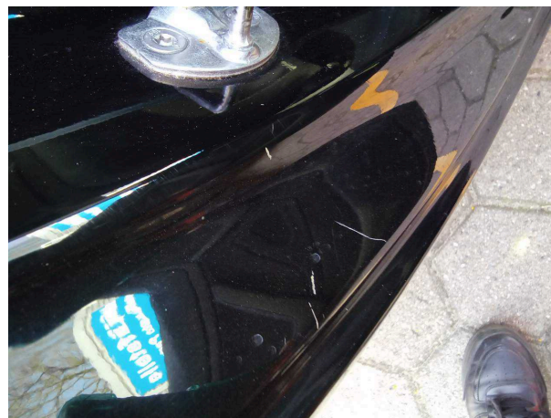
Beschädigung #4: Seitenwand rechts: Einstieg - Kratzer - Smart Repair
