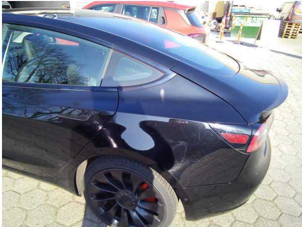
Beschädigung #6: Seitenwand links: Seitenwand (Vogelkot Verätzun... - Lackmangel - lackieren
