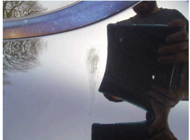
Beschädigung #6: Seitenwand links: Seitenwand (Vogelkot Verätzung) - Lackmangel - lackieren
