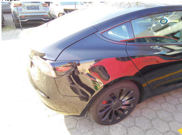
Beschädigung #5: Seitenwand rechts: Seitenwand (Orangenhaut) - nicht fachgerecht instandgesetzt - lackieren
