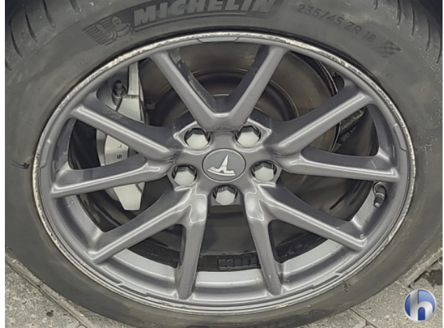
2. velg lv,la,ra,rv Beschadigd - Herstellen
