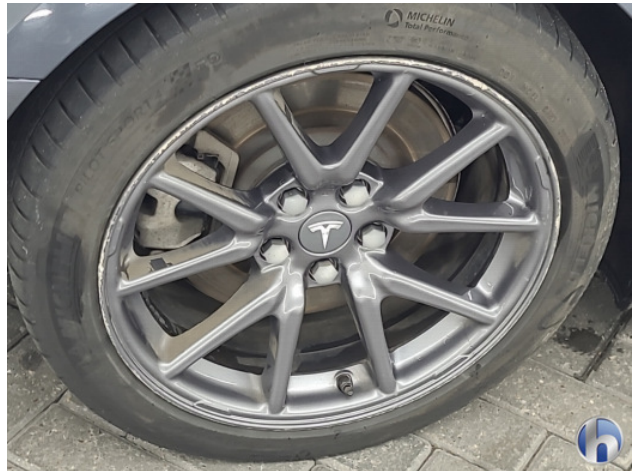
2. velg lv,la,ra,rv Beschadigd - Herstellen
