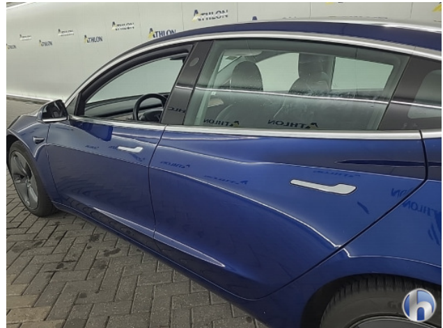
2. Portier achter - links Krassen - Spuiten
