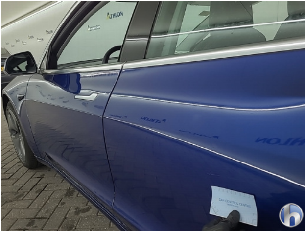
2. Portier achter - links Krassen - Spuiten
