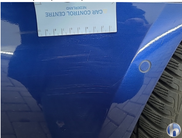
5. Achterbumper Krassen - Spot Repair/Deelreparatie
