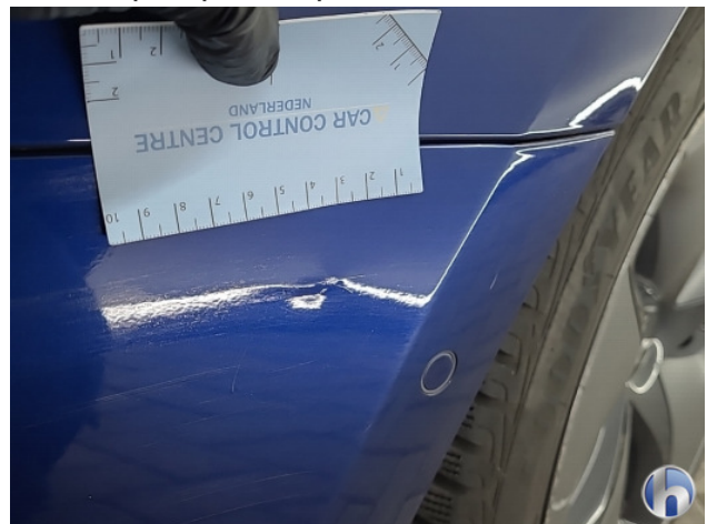
5. Achterbumper Krassen - Spot Repair/Deelreparatie
