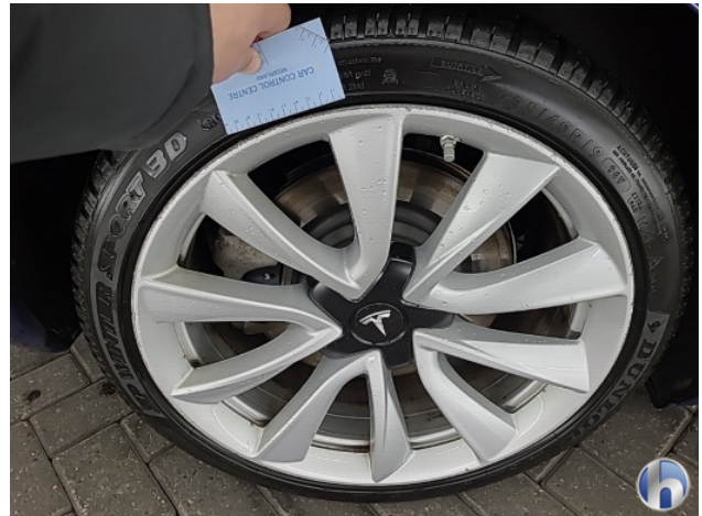
2. Velg achter- rechts Beschadigd - Herstellen
