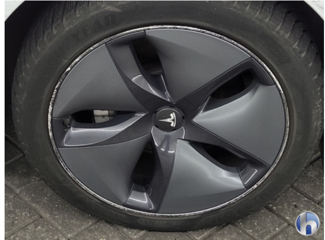
2. Velg achter - links Beschadigd - Herstellen
