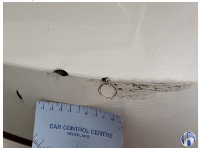
3. Achterbumper Brek / barst / scheur - Spot Repair/Deelreparatie
