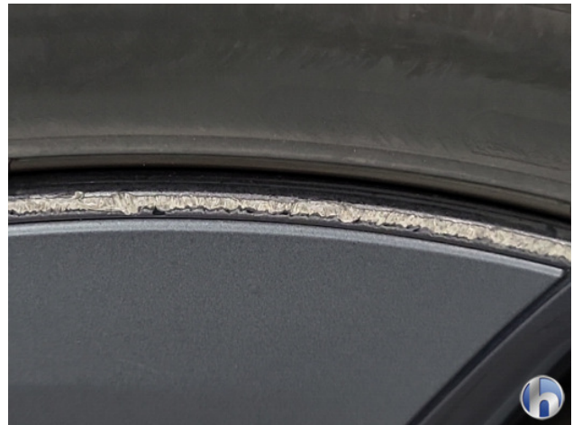
2. Velg achter - links Beschadigd - Herstellen
