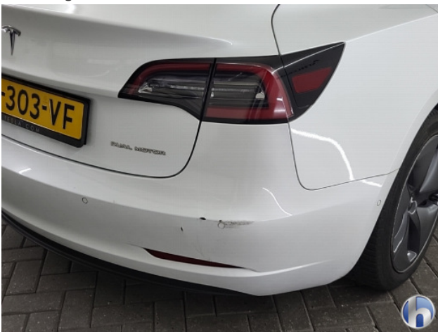
3. Achterbumper Brek / barst / scheur - Spot Repair/Deelreparatie
