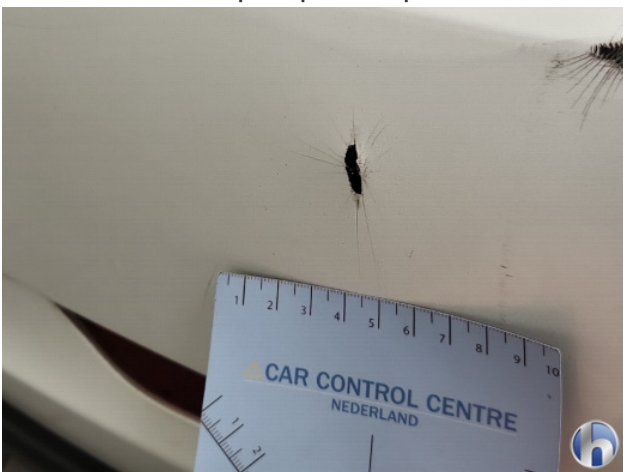
3. Achterbumper Brek / barst / scheur - Spot Repair/Deelreparatie
