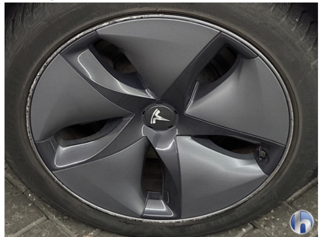
2. Velg achter - links Beschadigd - Herstellen
