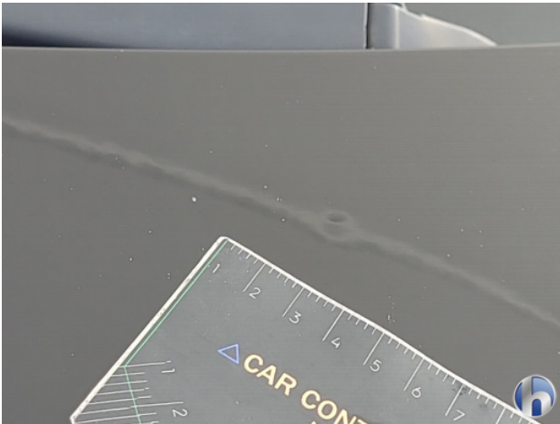
1. Motorkap Gebruikssporen - Aanvaardbaar
