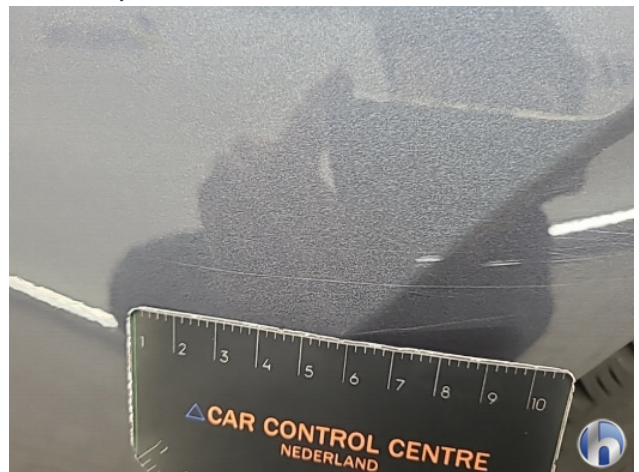
3. Zijwand - achter - rechts Krassen - Spuiten
