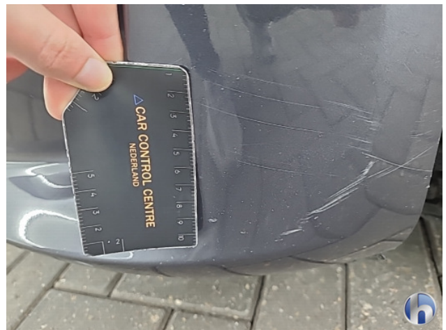
2. Voorbumper Krassen - Spot Repair/Deelreparatie
