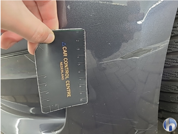
2. Voorbumper Krassen - Spot Repair/Deelreparatie
