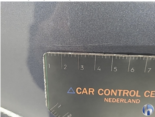
3. Zijwand - achter - rechts Krassen - Spuiten
