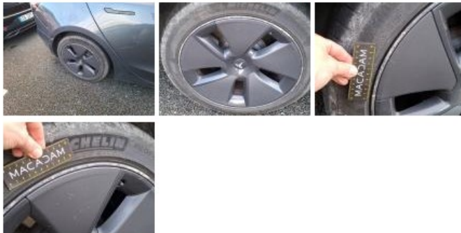
Alloy rim RL, Scratch(es), Repair/replace (lump sum)
