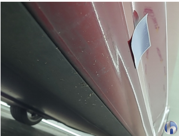
1. Dorpel - links Gebruikssporen - Aanvaardbaar
