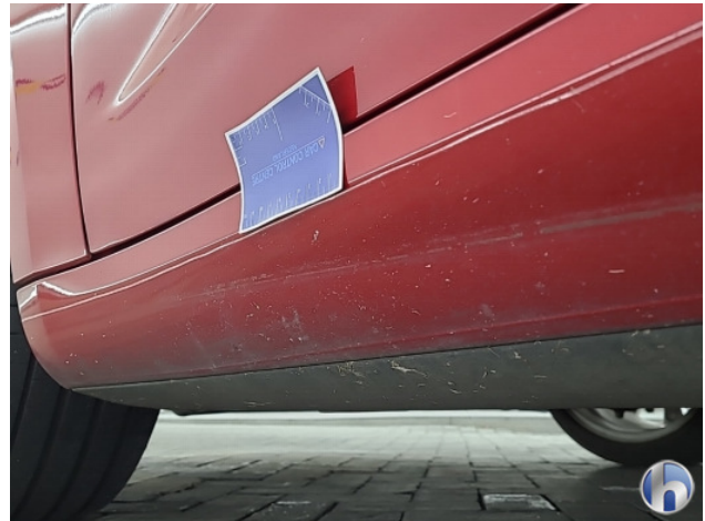
1. Dorpel - links Gebruikssporen - Aanvaardbaar
