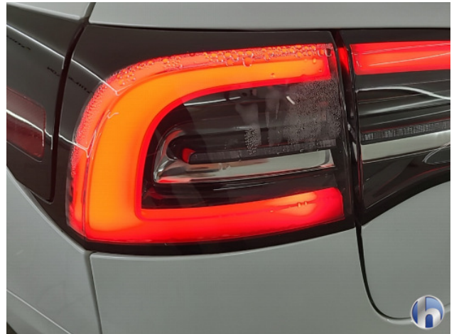
1. vocht achterlicht Gebruikssporen - Aanvaardbaar
