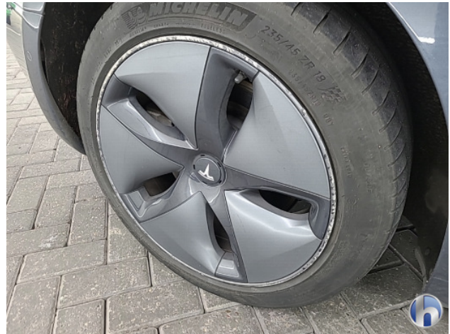
2. Diverse velgen Beschadigd - Herstellen
