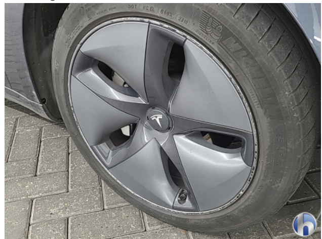
2. Diverse velgen Beschadigd - Herstellen
