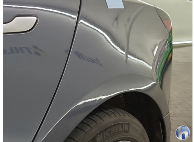
1. Slecht hersteld Gebruikssporen - Aanvaardbaar
