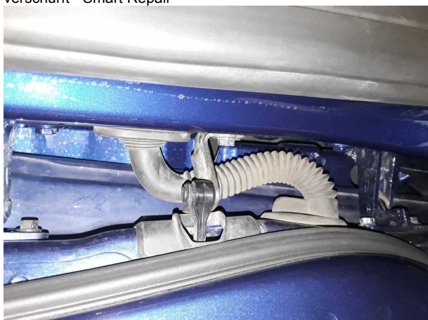
Beschädigung #3: Tür vorn links: Fangband / Feststeller - Geräusch - erneuern
