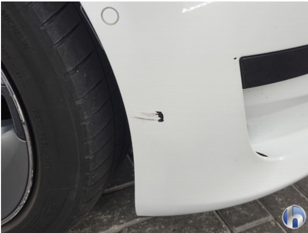
6. Voorbumper Schaafplek - Spot Repair/Deelreparatie
