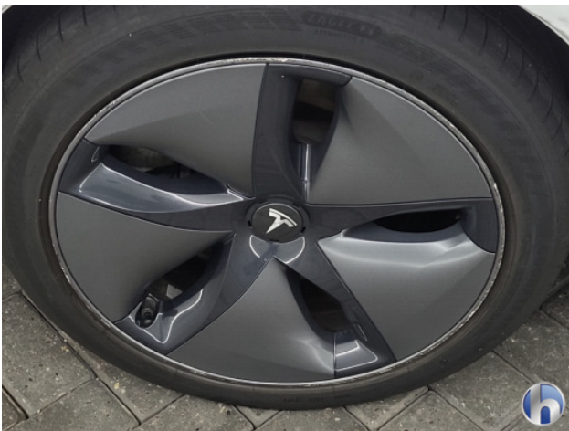
7. Velg voor - rechts Beschadigd - Herstellen
