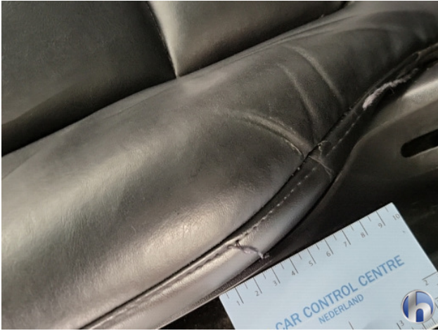
8. meerdere interieur schade Beschadigd - Vernieuwen
