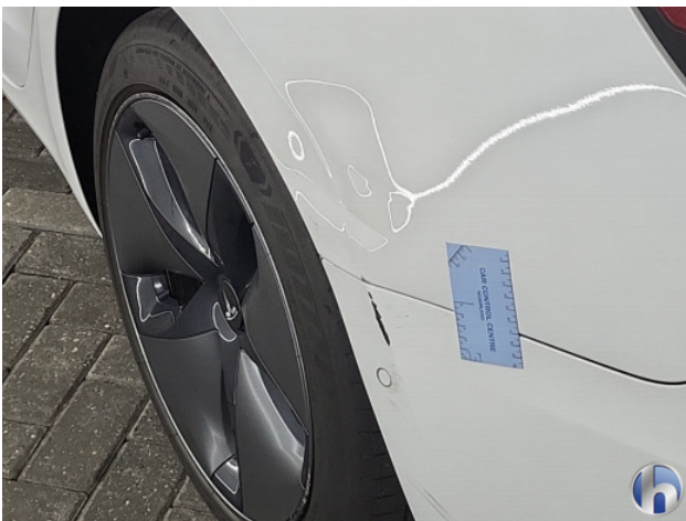
3. Zijwand - achter - Links Deuk/deuken - Herstellen
