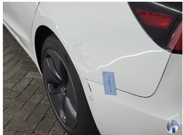
3. Zijwand - achter - Links Deuk/deuken - Herstellen
