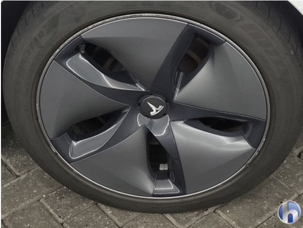
7. Velg voor - rechts Beschadigd - Herstellen
