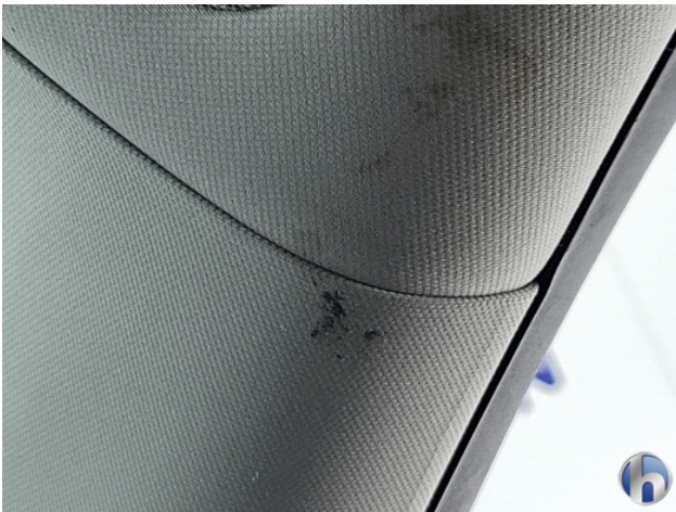
8. meerdere interieur schade Beschadigd - Vernieuwen
