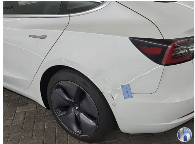
3. Zijwand - achter - Links Deuk/deuken - Herstellen
