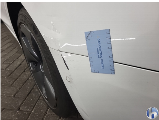
3. Zijwand - achter - Links Deuk/deuken - Herstellen
