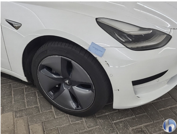
6. Voorbumper Schaafplek - Spot Repair/Deelreparatie
