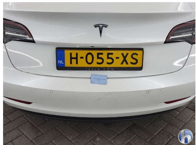
4. Achterbumper Krassen - Spot Repair/Deelreparatie
