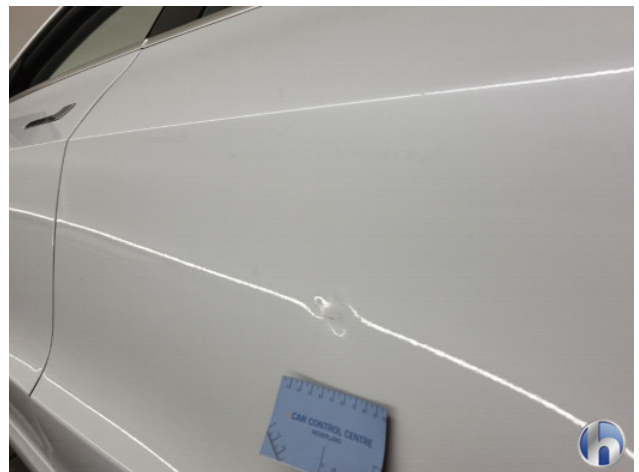
2. Portier achter - links Deuk/deuken - Herstellen
