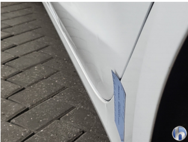
2. Portier achter - links Deuk/deuken - Herstellen
