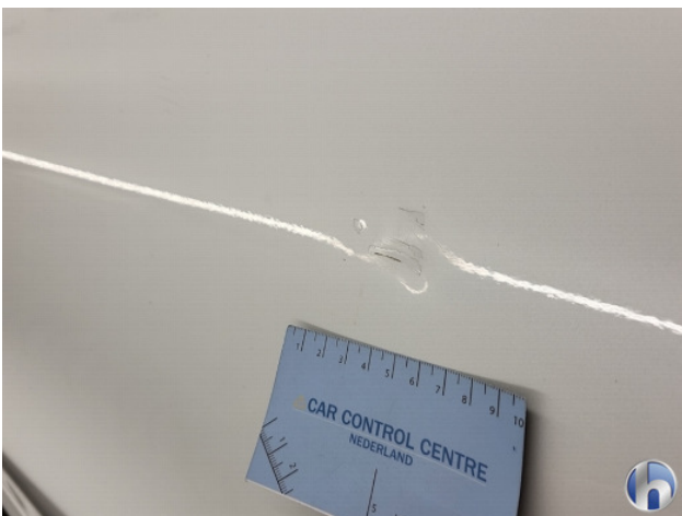
2. Portier achter - links Deuk/deuken - Herstellen
