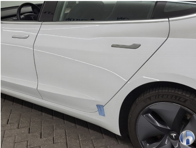
2. Portier achter - links Deuk/deuken - Herstellen
