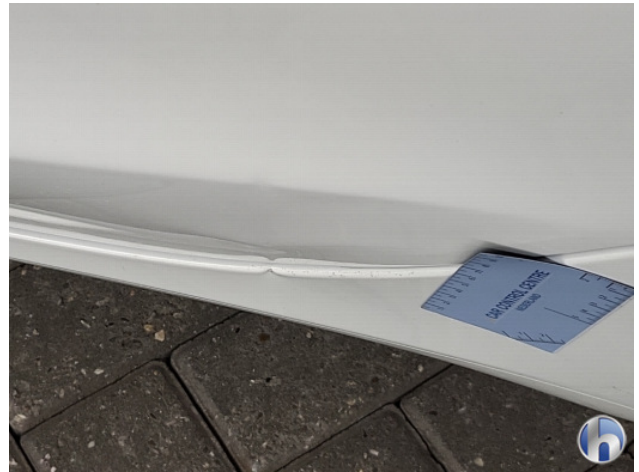
2. Portier achter - links Deuk/deuken - Herstellen
