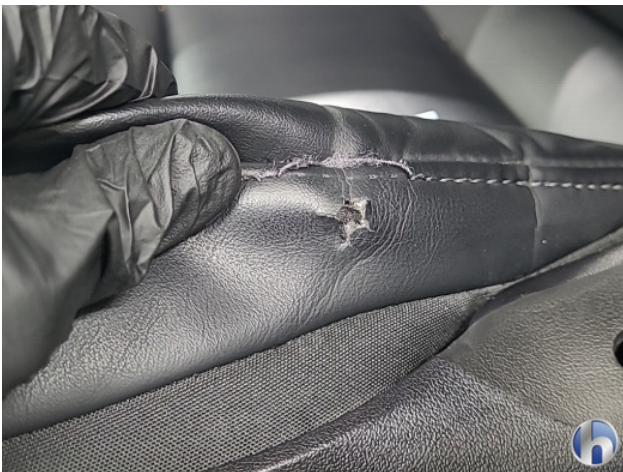
3. bestuurdersstoel Breuk / barst / scheur - Vernieuwen
