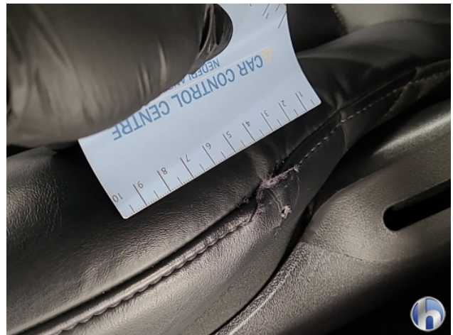
3. bestuurdersstoel Breuk / barst / scheur - Vernieuwen
