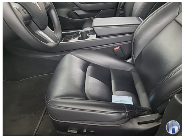
3. bestuurdersstoel Breuk / barst / scheur - Vernieuwen
