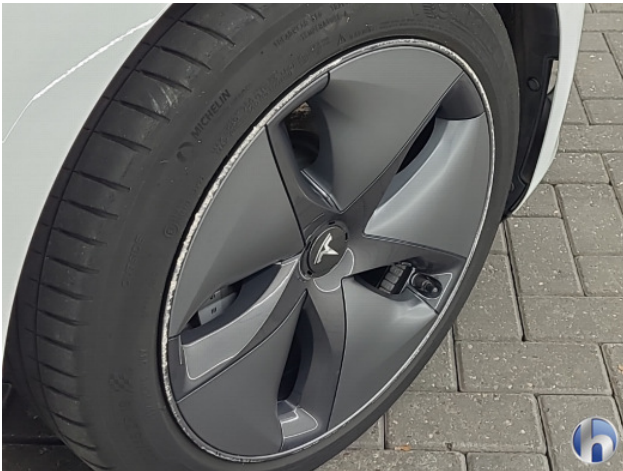
1. Velg voor - rechts Beschadigd - Aanvaardbaar
