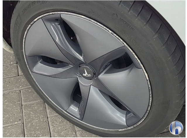
1. Velg voor - rechts Beschadigd - Aanvaardbaar
