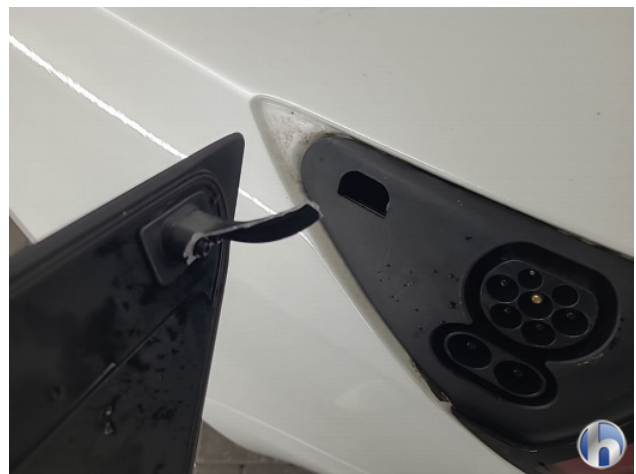
5. laadklep Breuk / barst / scheur - Aanvaardbaar
