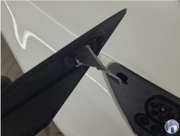
5. laadklep Breuk / barst / scheur - Aanvaardbaar
