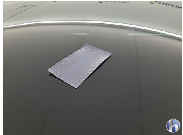
4. Dak Krassen - Aanvaardbaar
