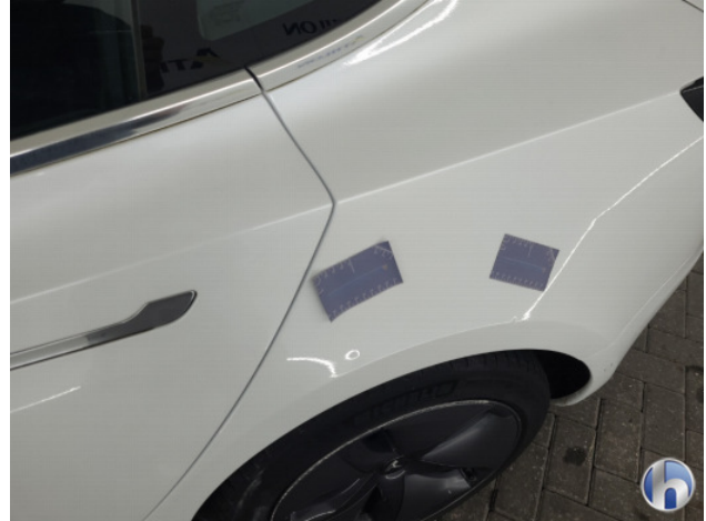
1. Zijwand - achter - Links Deuk/deuken - Herstellen
