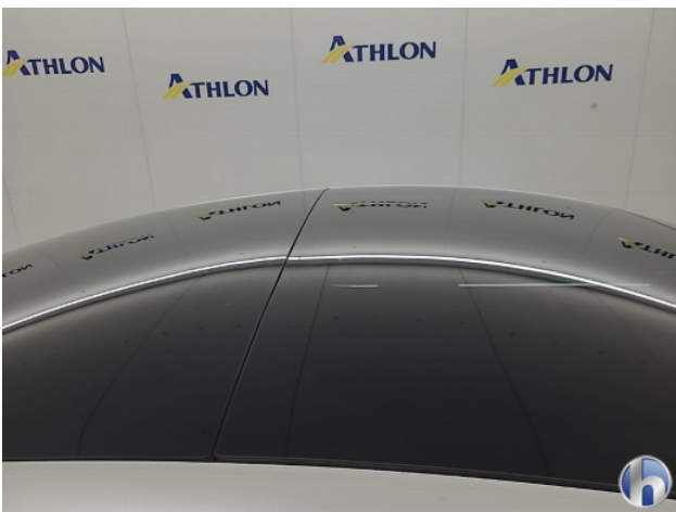
4. Dak Krassen - Aanvaardbaar
