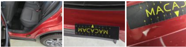
Porte ARG, Griffe(s), LI - Réparer et peindre (complet)
