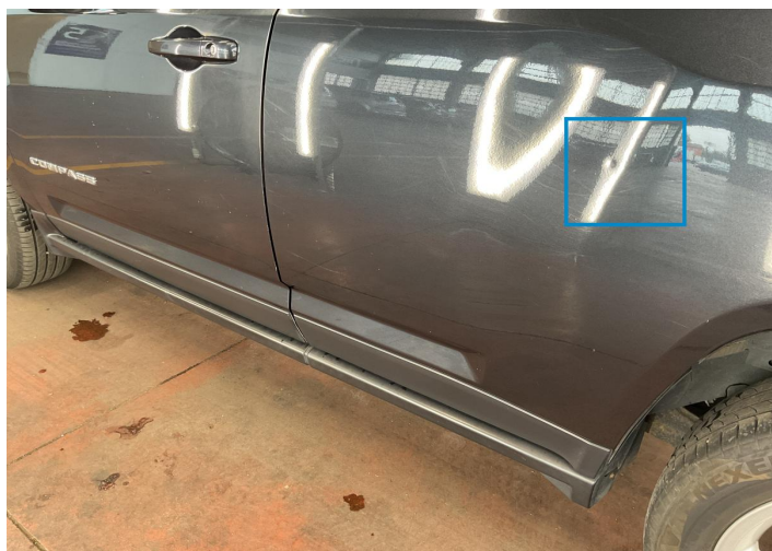
13. Door / Back Left Bodywork / Dent -
