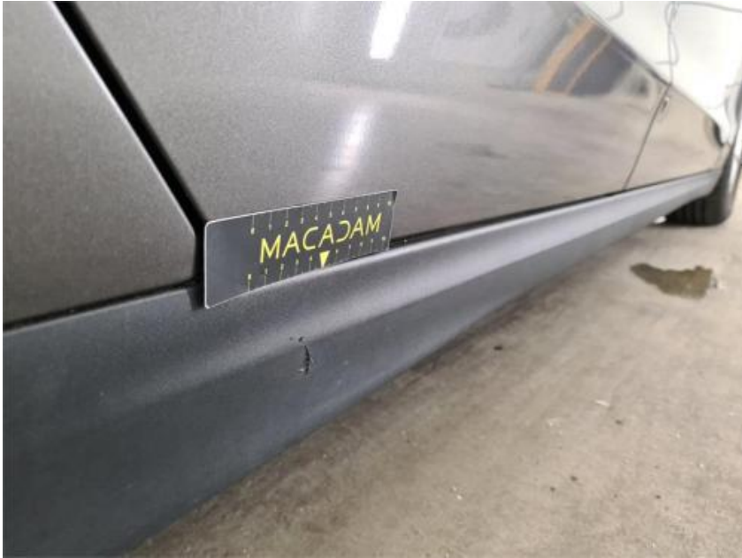
Dorpel R bekleding buiten: Vervormd / Geforceerd Repair method: Vervangen
