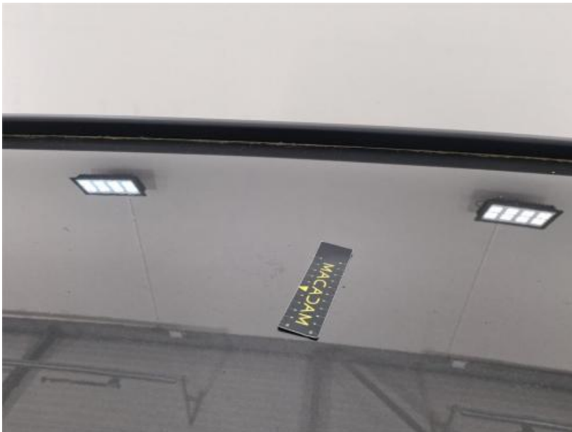
Dak: Chemische schade Repair method: LI - Herstellen en spuiten (compleet)
