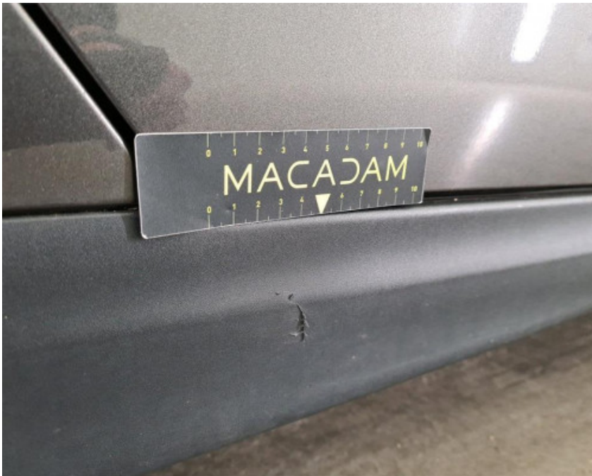
Dorpel R bekleding buiten: Vervormd / Geforceerd Repair method: Vervangen
