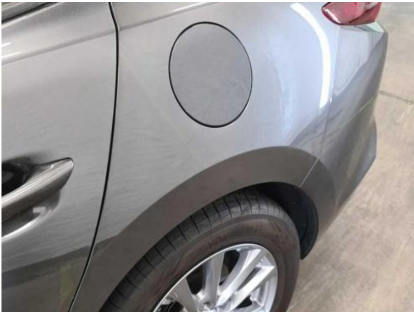
Scheren linksachter: deukje en krasjes Repair method: herstellen en spuiten
