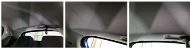
Dak, Chemische schade, Herstellen en spuiten (compleet)
