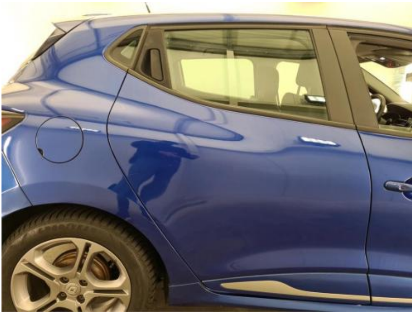
Deur A R: Kras(sen) Repair method: Herstellen en spuiten (compleet)
