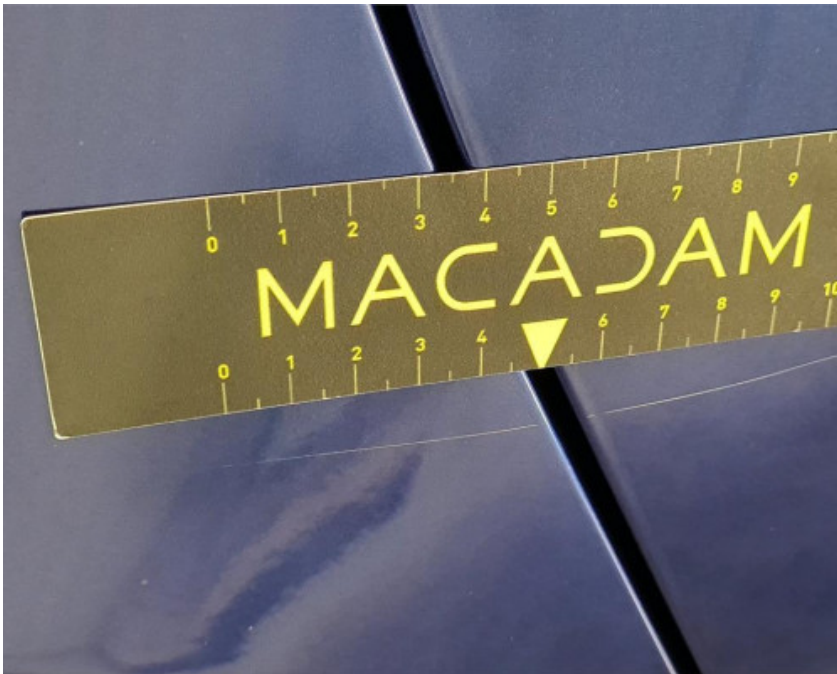
Scherf A R: Kras(sen) Repair method: Herstellen en spuiten (compleet)
