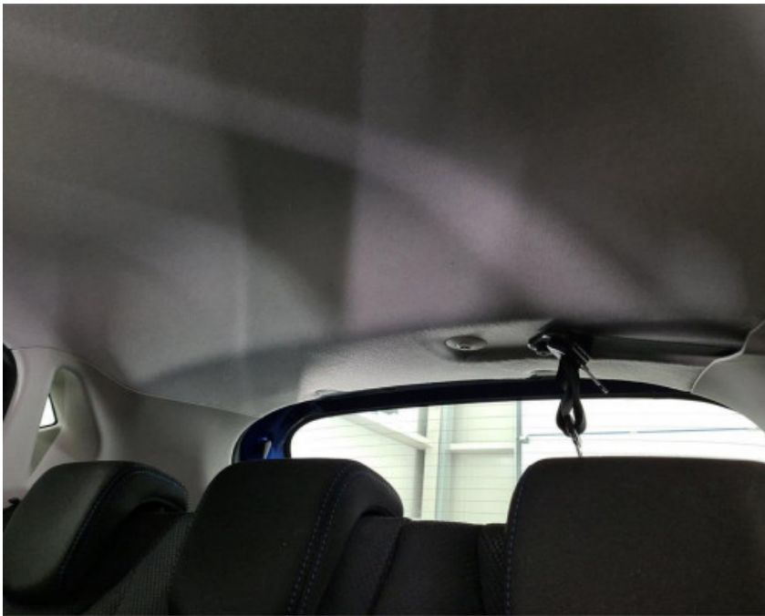
Hemelbekleding: Kras(sen) Repair method: Vervangen
