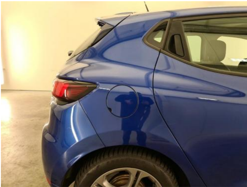
Scherf A R: Kras(sen) Repair method: Herstellen en spuiten (compleet)
