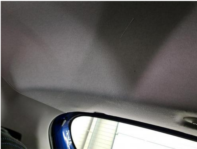
Hemelbekleding: Kras(sen) Repair method: Vervangen
