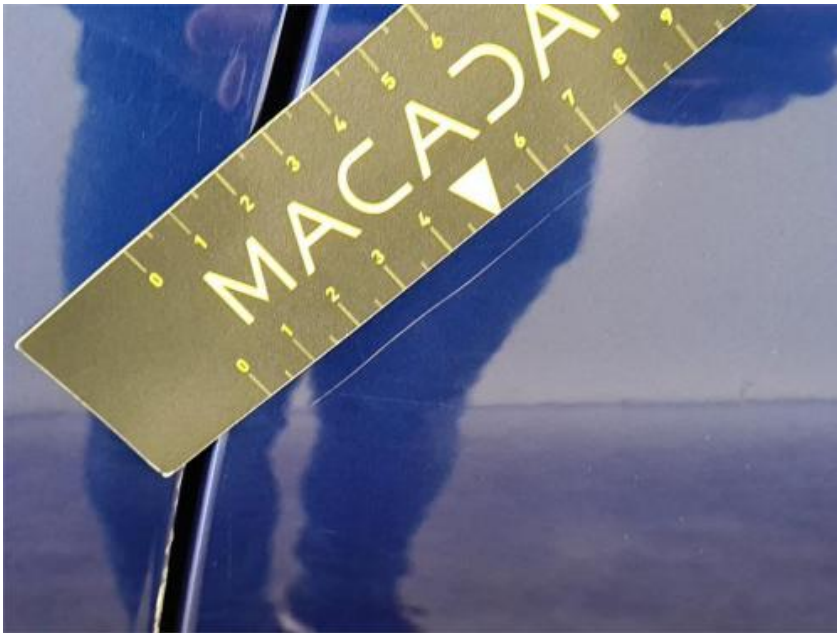
Deur A L: Kras(sen) Repair method: Herstellen en spuiten (compleet)
