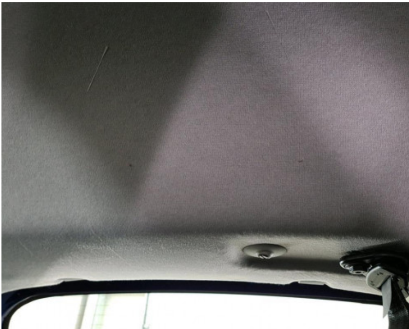
Hemelbekleding: Kras(sen) Repair method: Vervangen
