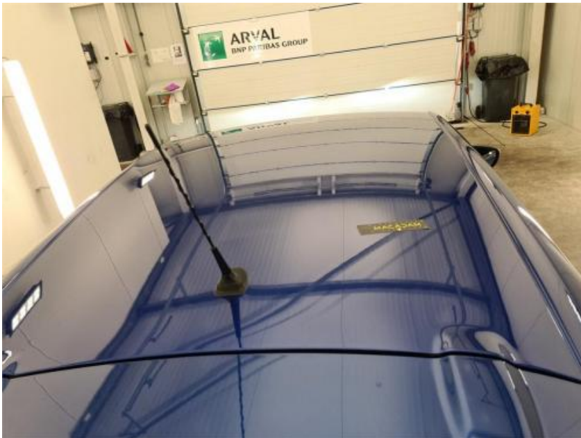
Dak: Chemische schade Repair method: Herstellen en spuiten (compleet)
